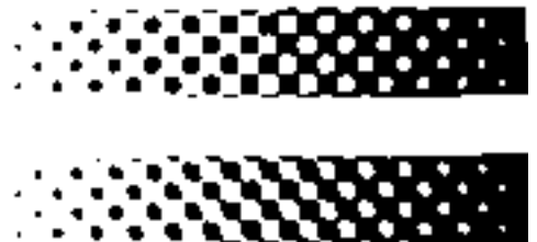
▲ Abb. 3.2: verschiedene Rasterpunktformen: obere Abb.: rund – quadratisch – rund untere Abb.: elliptisch (»Kettenpunktraster«) (Quelle: AGFA)
